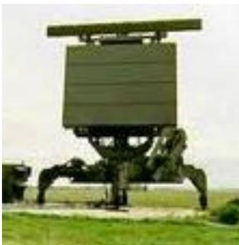
Le contrôle est définitivement arrêté à Narbonne où un radar volumétrique Thalés Raytheon System (TRS) 22XX et son secours TRS 2215 sont installés et connectés au SRIDA.
