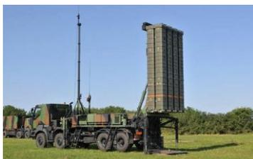
L'escadron EDSA 4/950 de Luxeuil dispose des deux premières sections SAMP/T « Mamba » (Sol-Air Moyenne-Portée /Terre) équipées de missiles Aster 30 capables d'atteindre des avions à 100 kilomètres et des missiles de croisière à 30 kilomètres.
