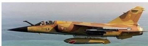
Avec la mise en service du Mirage F 1, les contrôleurs découvrent pour la première fois un intercepteur de conception française disposant d'une autonomie confortable avec son plein interne, du radar Cyrano IV de la THOMSON CSF doté de très bonnes performances et d'une conduite de tir efficace.
