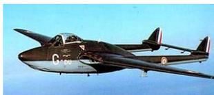
La 5<sup>ème</sup> Escadre de Chasse (EC) de retour d'Indochine avec ses Vampire est affectée à la DAT et se met en place à Orange. Ces avions fabriqués par de Havilland, sont équipés d'un turboréacteur Goblin et armés de quatre canons de 20mm Hispano.
