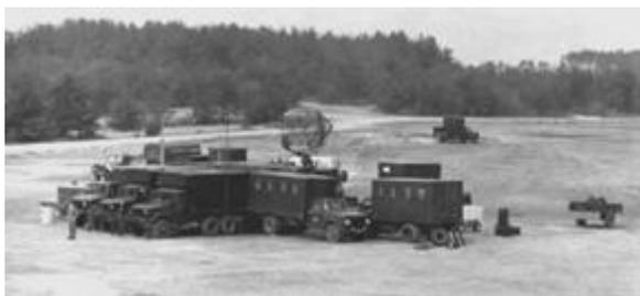
Dans la ZDA 902, des stations mobiles ont été laissées en place par les troupes de libération. Elles sont équipées du radar panoramique américain AN/TPS 1D, émettant dans la bande des 23 cm, l'altimétrie étant fournie par une ou plusieurs antennes à balancement (AN/TPS 10D); d'autres stations disposent de radars 14 et 13 britanniques.
