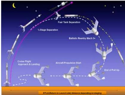
Après sa phase de rentrée atmosphérique, le module vole et se pose comme un drone, sur une piste adaptée, grâce à ses ailettes et à un système exclusif d'hélices déployables. Pendant toute la descente, les éléments destinés à être réutilisés auront été parfaitement protégés grâce à leur configuration en arrière du module de retour. De plus, Adeline ne nécessite pas d'infrastructure particulière pour l'accueillir sur Terre ; une piste d'aérodrome suffit !
